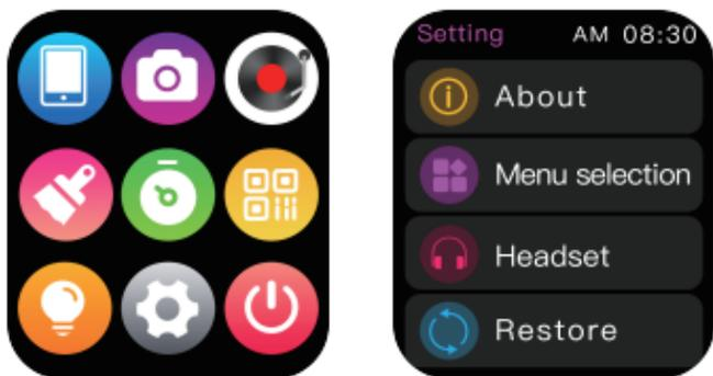
连接耳机使用说明: 打开 TWS 耳机后, 点击手环的连接耳机选项, 搜索到耳机后, 点击连接。如未搜索到: 1. 请点击图标或退出再进入, 再次搜索。2. 检查耳机是否是能被搜索状态。如搜索到但点击连接不成功, 请在首页下拉状态栏, 开关一次连接, 再进入搜索连接。
